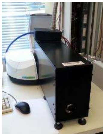
Εικόνα 3. Θερμαινόμενη γραμμή μεταφοράς και μετρητικό κελί, για τη φασματική ανάλυση αερίων με FTIR
