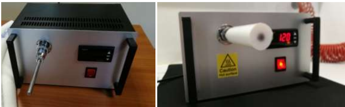
Εικόνα 1. Φωτογραφίες μετρητικής διάταξης για τον έλεγχο μονωτικών υλικών χαλκοσωλήνων ως προς την αντοχή τους σε υψηλές θερμοκρασίες
